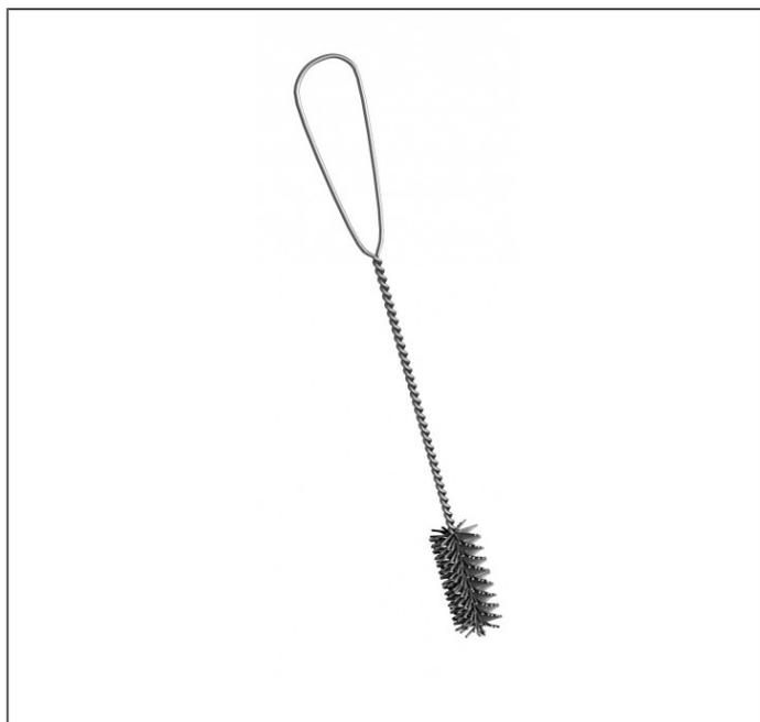
D'un poil très dur, l'écouvillon de nettoyage existe en deux tailles (ø17 et ø30 mm). Il est impératif de nettoyer le trou et de souffler la poussière avant l'injection de la résine (en corps pleins mais également en corps creux).
