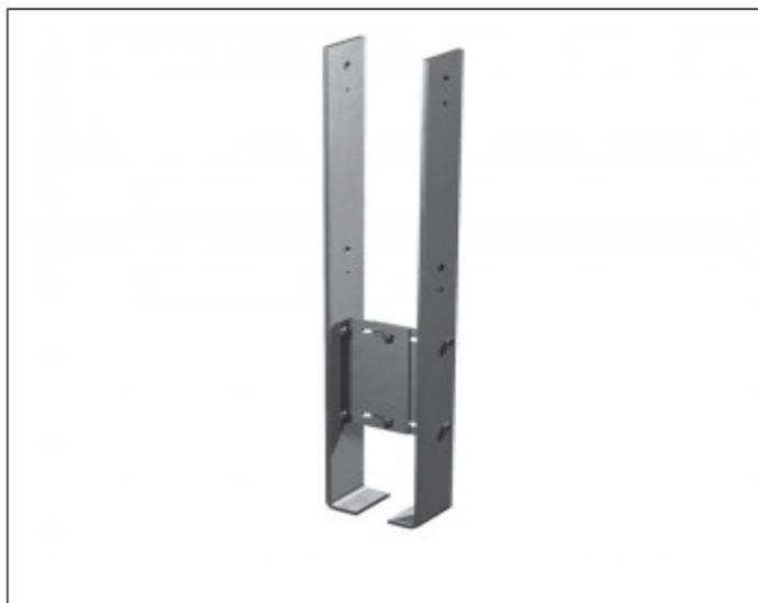
Les pieds de poteaux CMS sont constitués de deux pièces en acier galvanisé pour une utilisation en extérieur. Il s'agit d'un pied de poteau réglable en largeur pour des poteaux allant de 80 à 140 mm.
