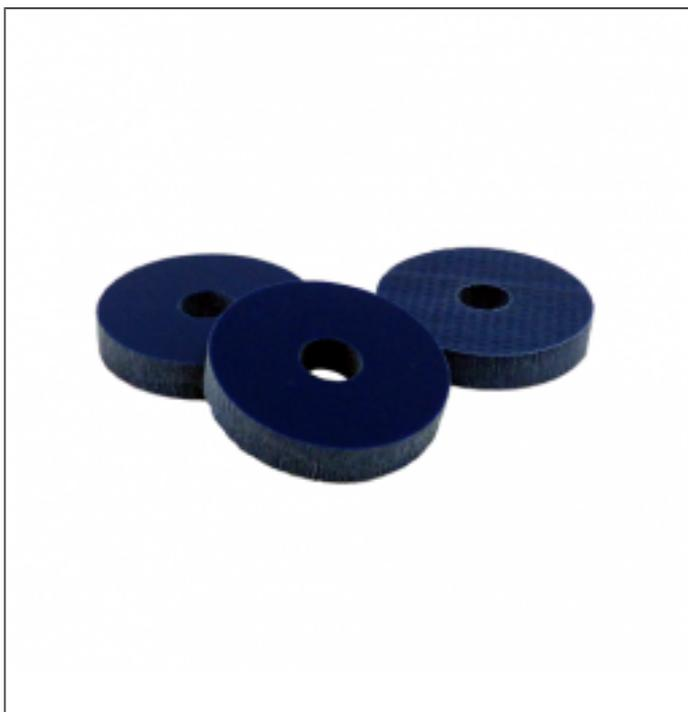
La rondelle SITW s'associe à la bande SIT pour constituer un système performant dans les structures en CLT devant respecter un haut niveau de performance acoustique. Elle s'intercale entre une rondelle métallique et le CLT lors de l'assemblage par vis, évitant la transmission des vibrations par les fixations.
