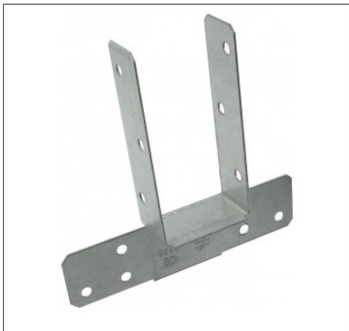
Les pieds de fermettes permettent un ancrage rapide et précis des fermettes, chevrons ou solivettes. Le modèle à plat est utilisé principalement pour reprendre des efforts horizontaux. Le modèle plié est plus adapté aux efforts de soulèvement importants.
